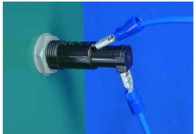
3. 接続した電線に張力がかからない様、電線を固定する
